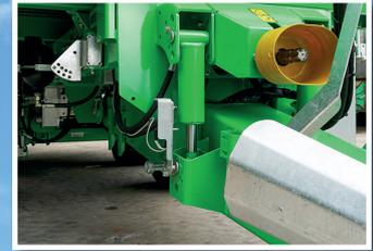
**Suspensión hidráulica de la lanza y de los ejes**
